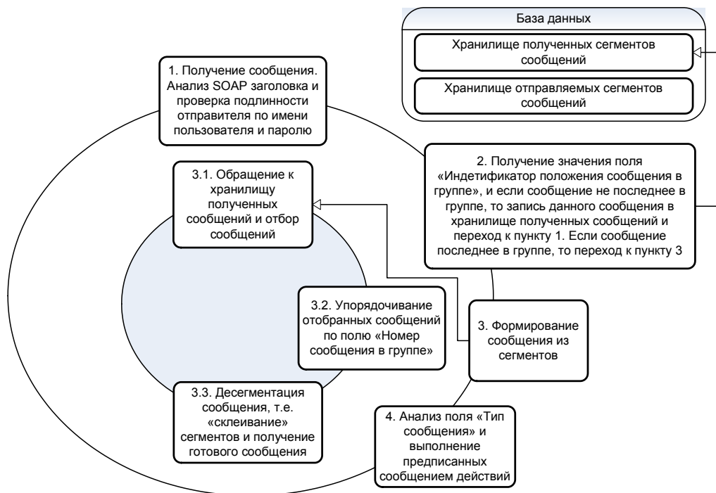
Рис. 4. Функционирование подсистемы обработки входящих сообщений
